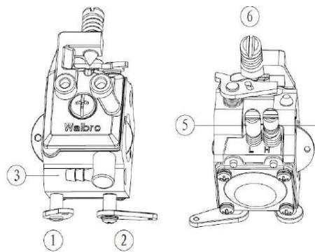
Čtyrtaktní benzínový motor NGH-GF30 používá karburátor Walbro WT. Má perfektní stabilitu volnoběžných otáček a citlivost zrychlení. Je lepší odstranit palivo z karburátoru po ukončení letů, zamezíte tomu, že se kvalita gumových součástí karburátoru zhorší, což by mohlo vést k selhání výkonu motoru. Metody: Nastartujte motor bez připojení paliva, dokud nebude palivo z karburátoru vyčerpáno.
