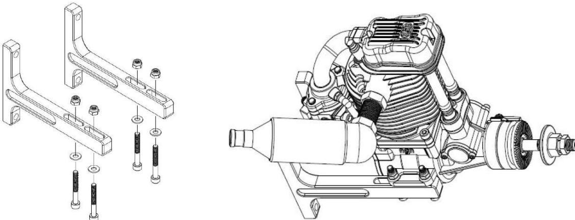
**Upozornění: Ujistěte se, že před zvletem nejsou uvolněné šrouby držáku ke stěně RC letadla.**
